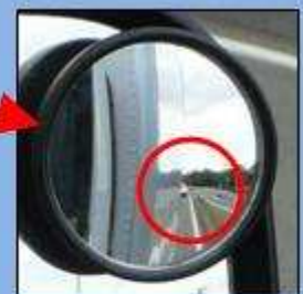
補助ミラーでは真後ろの緊急車両を確認できる。
